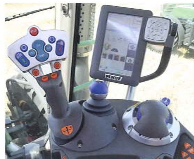
Die Basis-Version „Power“ kommt mit dem kleinen 7-Zoll-Bildschirm aus und verzichtet auf die ISO-Bus-Steuerung.
