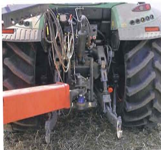
Das Hubwerk der neuen 500er hebt laut Hersteller knapp 7,8 Tonnen, die neue Funktion „Lastkompensiertes Senken“ ist Serie. Fotos: Neunaber, Werkbilder (2)
