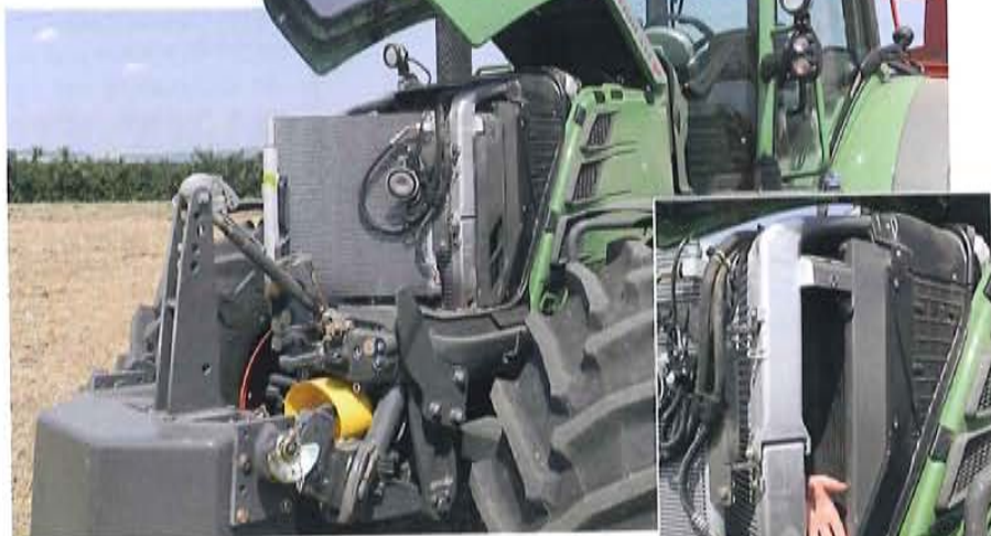
An das vorne „offene“ Dach muss man sich gewöhnen. Der SCR-Katalysator zur Abgasnachbehandlung findet sich auf der linken Seite, die Kühler sind „durchgreifbar“ und gut zu reinigen.
