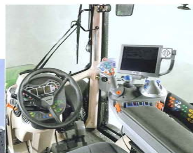
Die neue „VisioPlus“-Kabine in der Gesamtübersicht. Hier dann auch mit dem (bei „ProfiPlus“ serienmäßigen) 10,4-Zoll-Terminal mit „Touchscreen“ und natürlich mit ISO-Bus-Steuerung.
