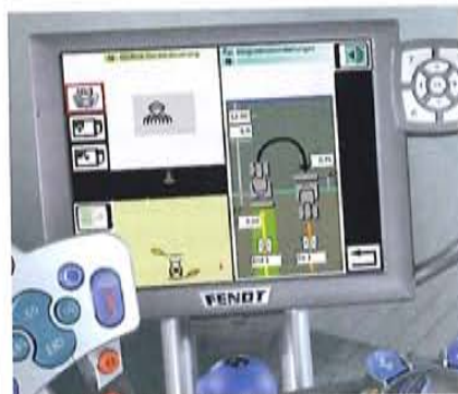
Erstmals kann das Vorgewende-Management im 500 Vario über die GPS-Position automatisch ausgelöst werden.
