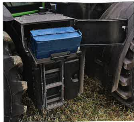
Auf der rechten Seite gibt es einen ausziehbaren Werkzeugkasten oder wahlweise einen 12-l-Handwaschbehälter.
