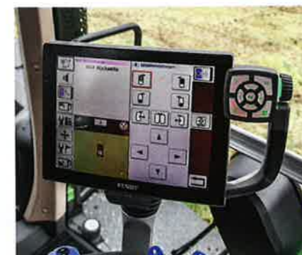
...die komplett ins Terminal integriert ist. Dazu werden die Spiegel heute über den Can-Bus des Schleppers angesteuert.
