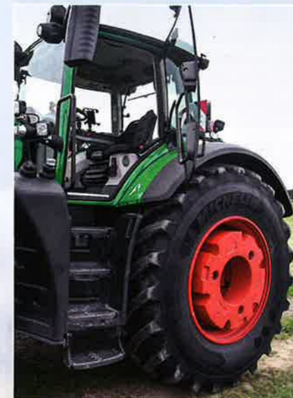
625 l Diesel und 70 l AdBlue hat der neue 900er an Bord. Die neue mit Trelleborg entwickelte Reifengröße ist VF750/70 R 44.
