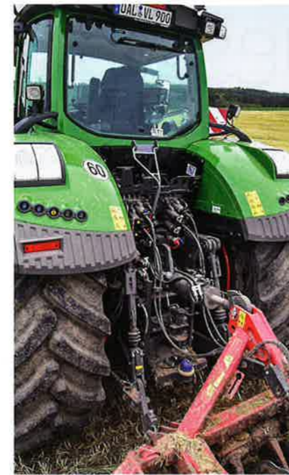
Auch bei der Hydraulik hat der neue 900er das Gleiche zu bieten wie der 1000er: bis zu 430 l/min mit zwei getrennten Kreisläufen und bis zu 170 l/min Durchflussmenge bei zwei Ventilen.
