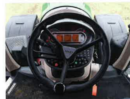
Die Bedienung von Licht und Lüftung sitzt nach wie vor unter dem Lenkrad. Unten auch der Schnellzugriff für die Spiegel-Einstellung...
