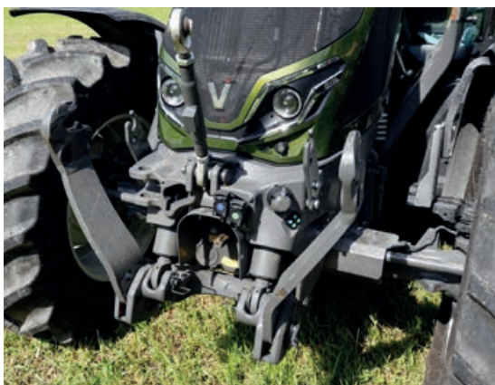
Das vollintegrierte Fronthubwerk stemmt durchgehend 2.900 kg.
