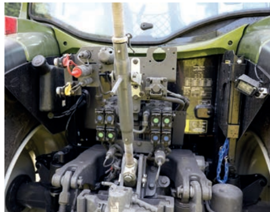
Im Heck sind bis zu vier elektronische Steuerventile, ein „schwarz/weiß“-Ventil, LS-Anschlüsse sowie zwei verschieden große Rückläufe möglich.
