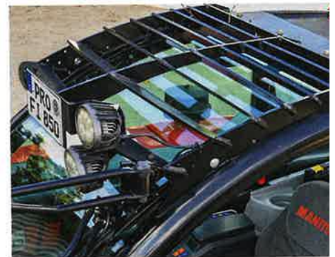
Das außenliegende Dachgitter mit den geneigten Stegen ist prima – der Nummernschildhalter hier dagegen fehlt am Platz.
