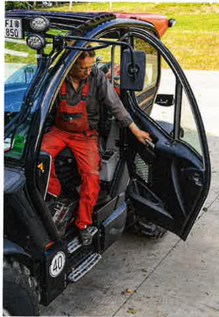
Die nach innen gezogenen Trittstufen machen den Ein- und Ausstieg sehr komfortabel.
